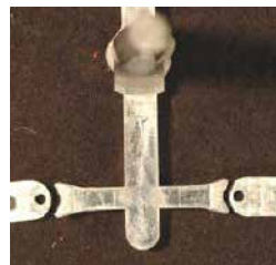
圖3: 缺陷產品的流道設計
